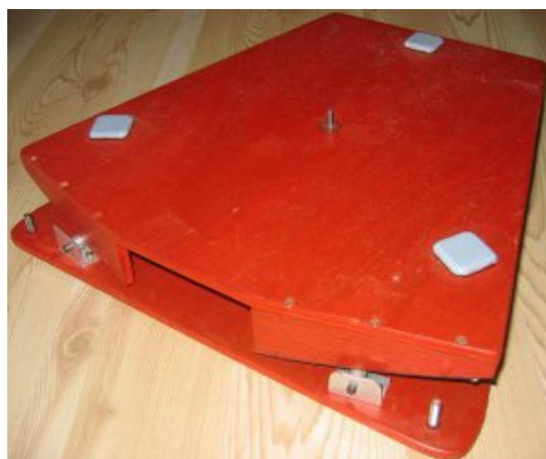
▲ Tavola equatoriale amatoriale per un riflettore portatile da osservazione visuale
