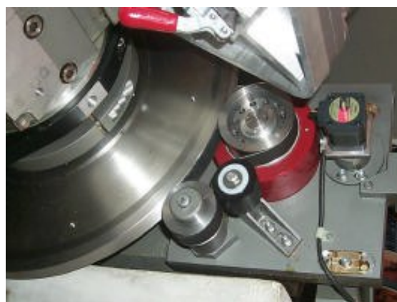
▲ Trascinamento a cinghia tractor drive di D. Britz
