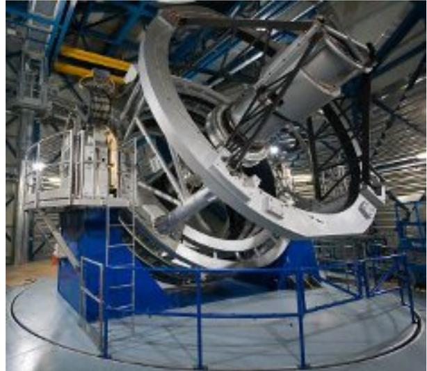
**VISTA** Acronimo di *Visible and Infrared Survey telescope for Astronomy* un telescopio da poco entrato in funzione all'**ESO** dedicato all'infrarosso, finalizzato a realizzare una mappa del cielo in questa lunghezza d'onda.
