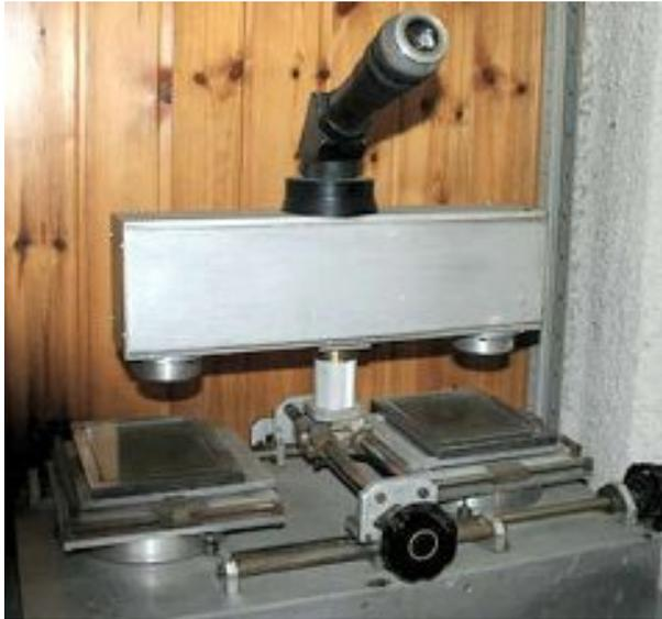
Le due lastre sono illuminate da una sorgente artificiale che può illuminarle entrambe oppure alternativamente l'una o l'altra. Una volta che le lastre sono state allineate con micrometrica precisione, nella visione binoculare le due immagini si sovrappongono, originandone una soltanto.
