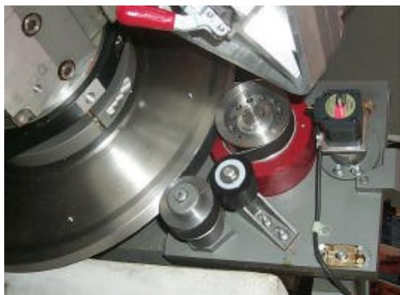
▲ Trascinamento a cinghia *tractor drive* di D. Britz
