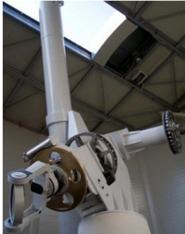
L'intera costruzione ottica e meccanica è stata realizzata in Italia. Il telescopio ha un'obiettivo di 300 mm della ditta **Zen**, ed è costituito da un obiettivo apocromatico spaziatizzato con focale di 5 m (F/16,7).
